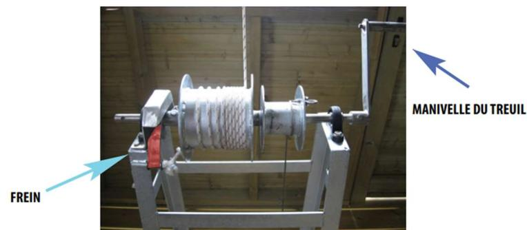
Le système de treuil permettant la mise à l'eau du carrelet est équipé d'un contre-poids afin de réduire les efforts et d'éviter les retours de manivelle. Un système de freinage permet l'utilisation du treuil en toute sécurité.
